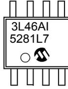
3 线 8 引脚 MSOP 封装标识
